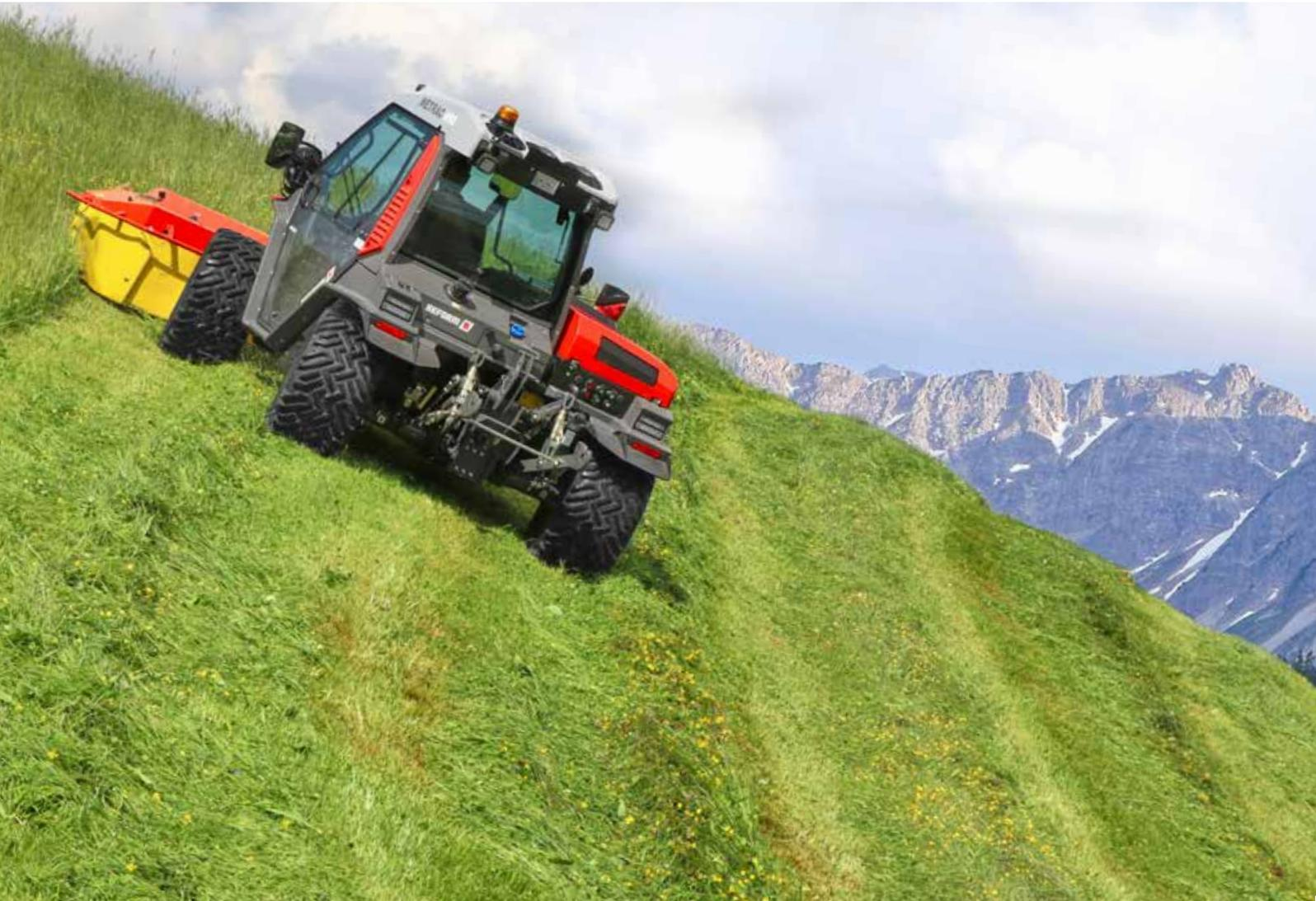
Das intelligente Allrad-Lenkensystem der Metrac ermöglicht 5 Lenkungsarten: Front-, Heck-, Allrad- und Hundeganglenkung sowie die versetzte Allradlenkung.
