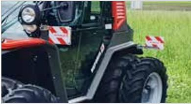
Warntafel für Zusatzbereifung
